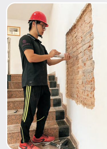
回弹法检测烧结砖强度
